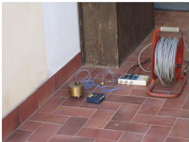
Figura 6 – Posizione del sensore triassiale indicato nella schema di Fig. 5 con il n° 6 (ingresso della casa)
